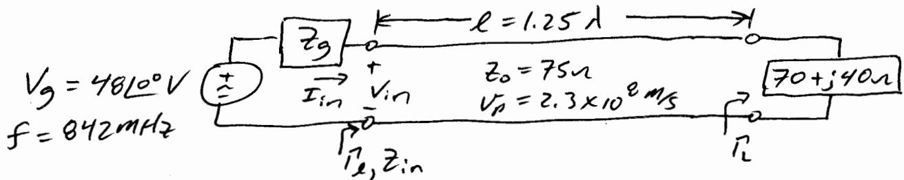
$$V_g := 48 \cdot e^{j \cdot 0 \cdot \frac{\pi}{180}} \quad V \quad f := 842 \cdot 10^6 \quad \text{Hz} \quad Z_L := 70 + j \cdot 40 \quad \Omega$$
