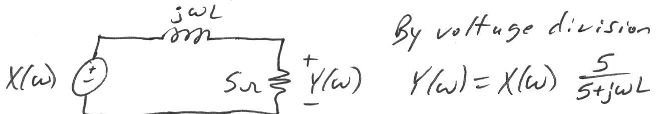
$$H(\omega) = \frac{Y(\omega)}{X(\omega)} = \frac{5}{5+j\omega L}$$
